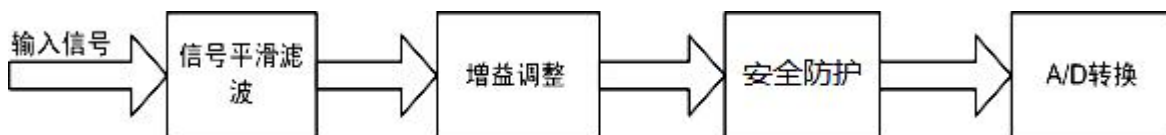
模拟量输入采样前端调理电路图
