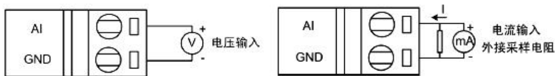
模拟量单端输入接线方式图
