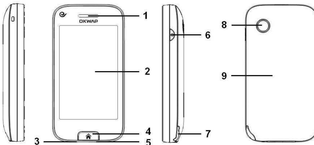
1 听筒/扬声器；2 屏幕；3 耳机插孔；4 Home 键；5 USB/充电接口；6 电源键；7 手写笔；8 摄像头（200 万像素）；9 后盖
