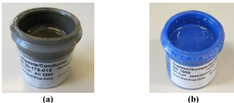
**Figura 60. (a) Pasta conductora SR 20-175-015HVS. (b) Pasta dieléctrica SD1000HVS.**
