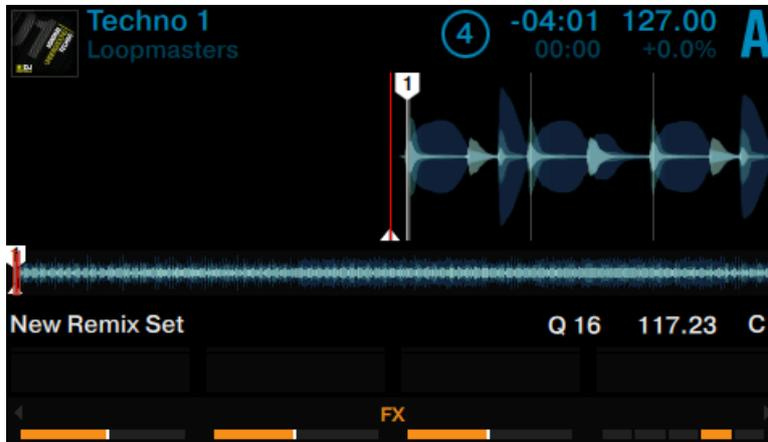
3. LOOP エンコーダーを回して取り込みサイズを変更します。
