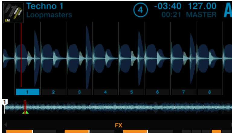
3. 8 個のパッドを用いて各スライスをトリガーします。
