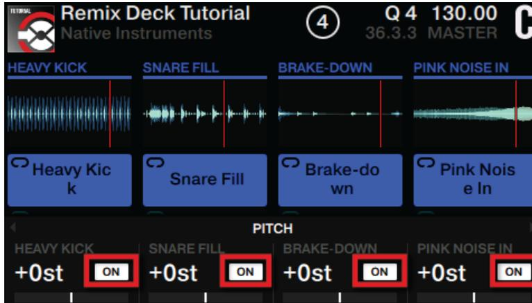
2. パフォーマンスノブを時計回り、または反時計回りに回して各サンプルのピッチを調節します。
