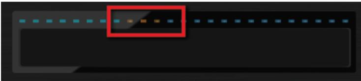
LED セグメントはトラックの全長を示します。3つのオレンジセグメントがトラックの現在の再生位置を表示します。
