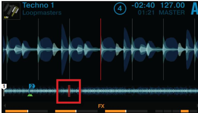
1. **SHIFT** を押したままオレンジ LED の下のタッチストリップ部分に触れ、スワイプするとトラック波形の前方に移動します。
