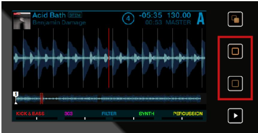
2. 点灯していないディスプレイボタンを押して表示内容を切り替えます。
