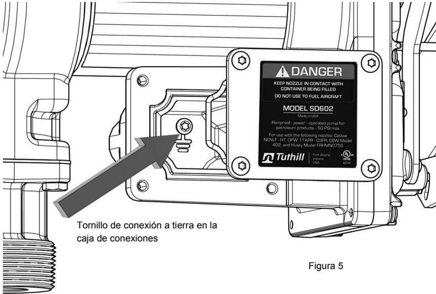
Tornillo de conexión a tierra en la caja de conexiones
