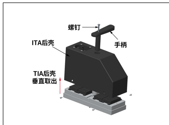
图 F:接收器框架安装
