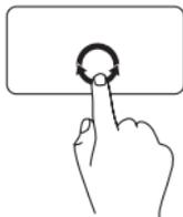
Déplacez un doigt en cercle dans la zone de défilement horizontal (partie inférieure de la tablette tactile), dans le sens des aiguilles d'une montre pour un défilement vers la droite, dans le sens inverse des aiguilles d'une montre pour un défilement vers la gauche.
