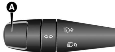
Las luces de carretera se desactivan volviendo a colocar la palanca en la posición central estable.
