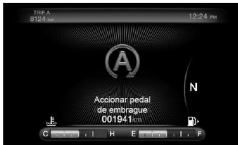
Si no se pressiona el pedal de embrague en aproximadamente 3 minutos, un mensaje será exhibido en la pantalla (Off o Start&Stop no disponible); en ese caso el rearranque automático estará deshabilitado, siendo necesario efectuar el nuevo arranque del vehículo a través de la llave de arranque.
