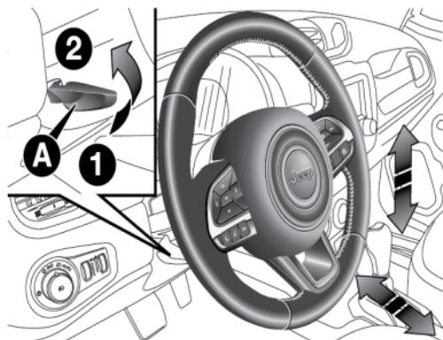
El volante puede ajustarse en altura y en profundidad.
