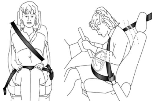
La correa del cinturón de seguridad no debe estar retorcida. La parte superior debe pasar por el hombro y atravesar diagonalmente el tronco. La parte inferior debe adherir a las caderas y no al abdomen del ocupante. No utilizar dispositivos (resortes, grampas, seguros, etc.) que impidan el contacto del cinturón con el cuerpo de los pasajeros.
