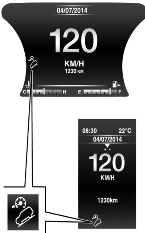
Con la palanca de cambios en punto muerto, no está disponible la regulación de la velocidad mediante el pedal acelerador.
