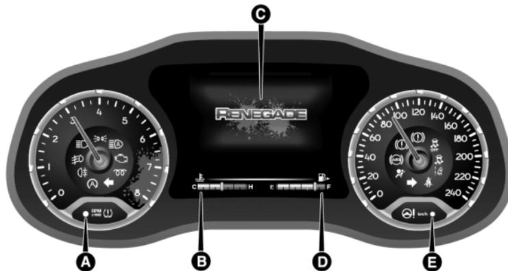
A- Tacómetro B- Indicador digital de temperatura del líquido de refrigeración del motor C- Pantalla multifunción D- Indicador digital del nivel de combustible (el triángulo
