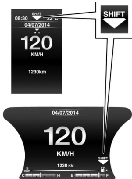
A través del GSI, el conductor es informado de que el paso a otra marcha permitiría una reducción del consumo.
