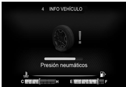
El sistema iTPMS avisa al conductor sobre la eventual presencia de una condición de presión de llenado diferente de la condición en el momento de la puesta a cero, si esa presión baja a un valor inferior al límite de advertencia por cualquier motivo, incluyendo los efectos de la baja temperatura y la normal pérdida de presión del neumático.
