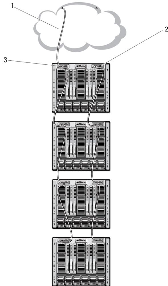
**Figure 2. Réseau CMC en chaîne**
