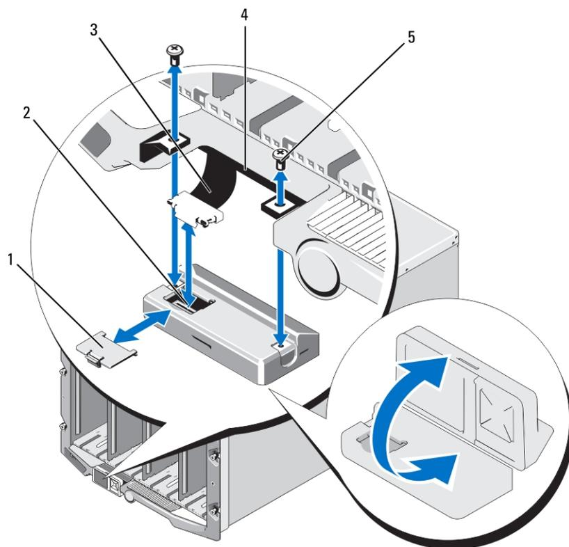
Figure 20. Retrait et installation du module LCD
