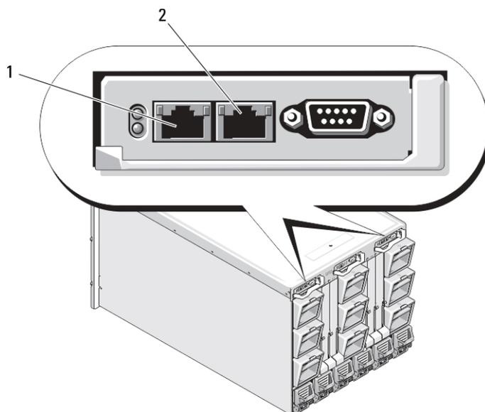
Figure 1. Emplacement des logements CMC dans le châssis
