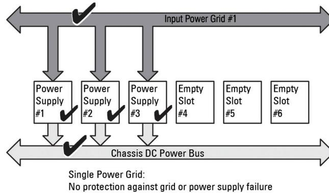
**Figure 16. Mode Sans redondance avec trois blocs d'alimentation dans le châssis**
