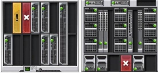
La página **Condición del chasis** ofrece el estado de la condición general del chasis, los CMC activos y en espera, los módulos de servidor, los módulos de E/S, los ventiladores, iKVM, los suministros de energía (unidades de suministro de energía) y la pantalla LCD. Al hacer clic sobre un componente se obtiene más información detallada sobre el componente. Para obtener instrucciones acerca de cómo ver el chasis y los resúmenes de los componentes, ver [Cómo ver los resúmenes del chasis](#).
