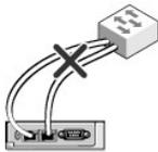
**Ilustración 2-4. Cableado incorrecto para la conexión de red de CMC: dos CMC**
