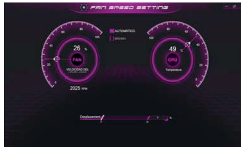
Figura 9 - Control de velocidad de FAN
