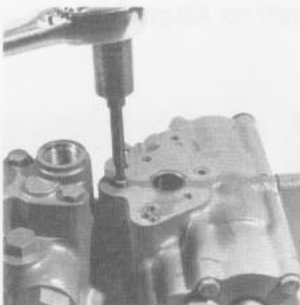
Fig. 79 - Remove Passage Plug
