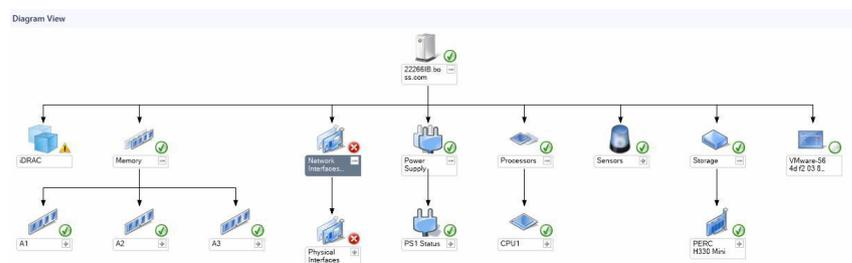
**Ilustración 1. Diagrama de instancia del servidor Dell**
