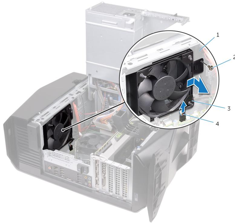
**图 6: 卸下机箱顶部风扇**
