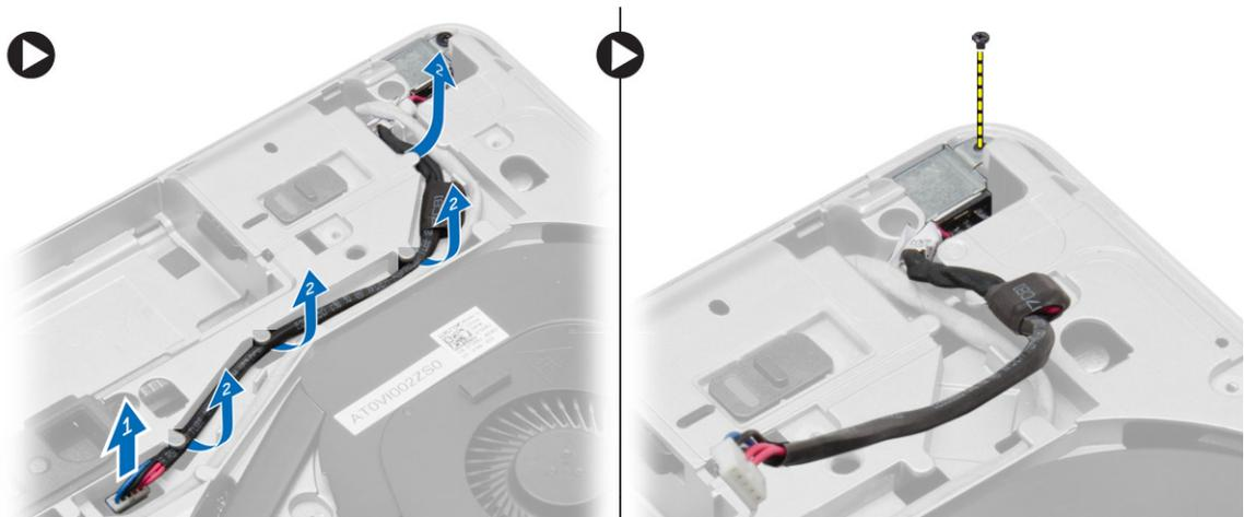
4. Levante el soporte del conector de alimentación del equipo. Levante el conector de alimentación del equipo.
