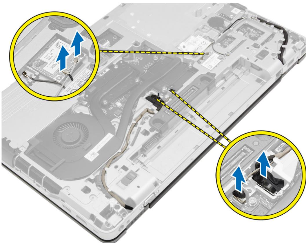
4. Desconecte el cable LVDS y suelte el cable LVDS y el cable de la cámara del canal de encaminamiento. Retírelos del equipo.
