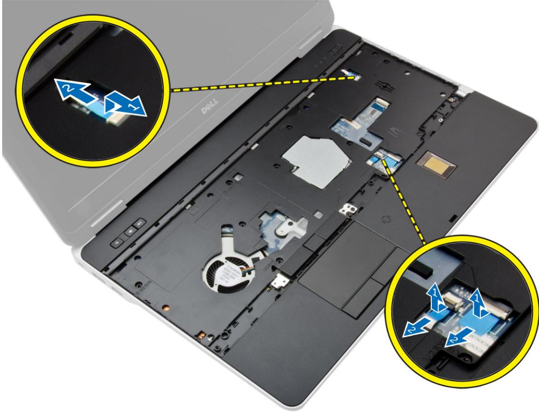
6. Haga palanca para levantar el ensamblaje del reposamanos hacia arriba y extráigalo del ordenador.
