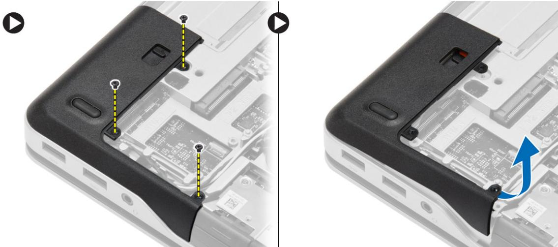
5. Extraiga los tornillos que fijan la cubierta de la esquina de la base de la derecha, levántela y extráigala del equipo.
