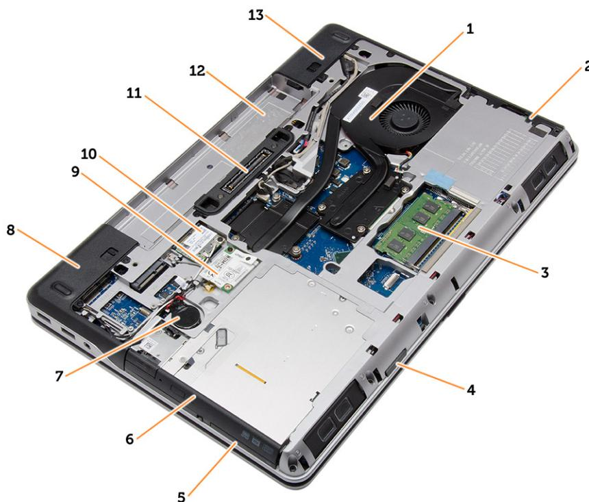
**Ilustración 1. Vista posterior: Se quitó la cubierta posterior**
