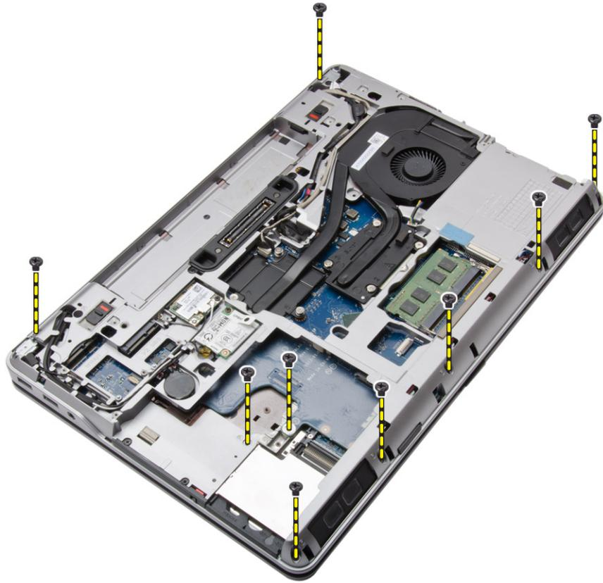
4. Dé la vuelta al equipo y quite los tornillos que fijan el ensamblaje del reposamanos al equipo.
