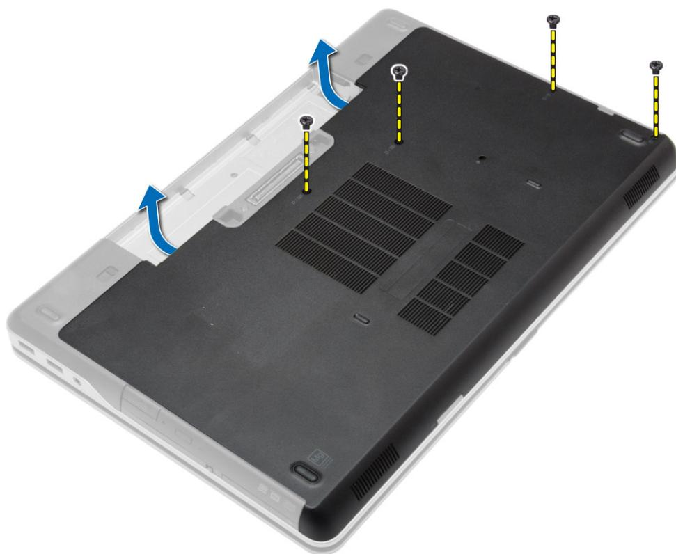
3. Levante la cubierta de la base y extráigala del equipo.
