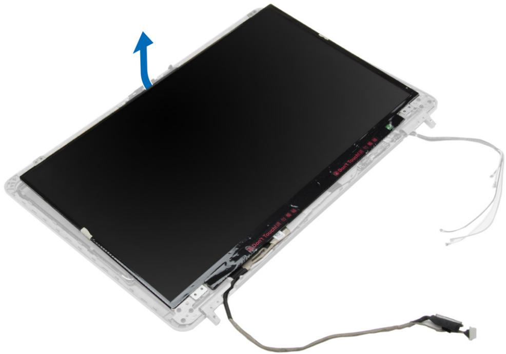
5. Despegue el cable LVDS de cinta del conector y desconecte el cable LVDS del panel de la pantalla y solución de problemas. Retire el panel de la pantalla del ensamblaje de la pantalla.
