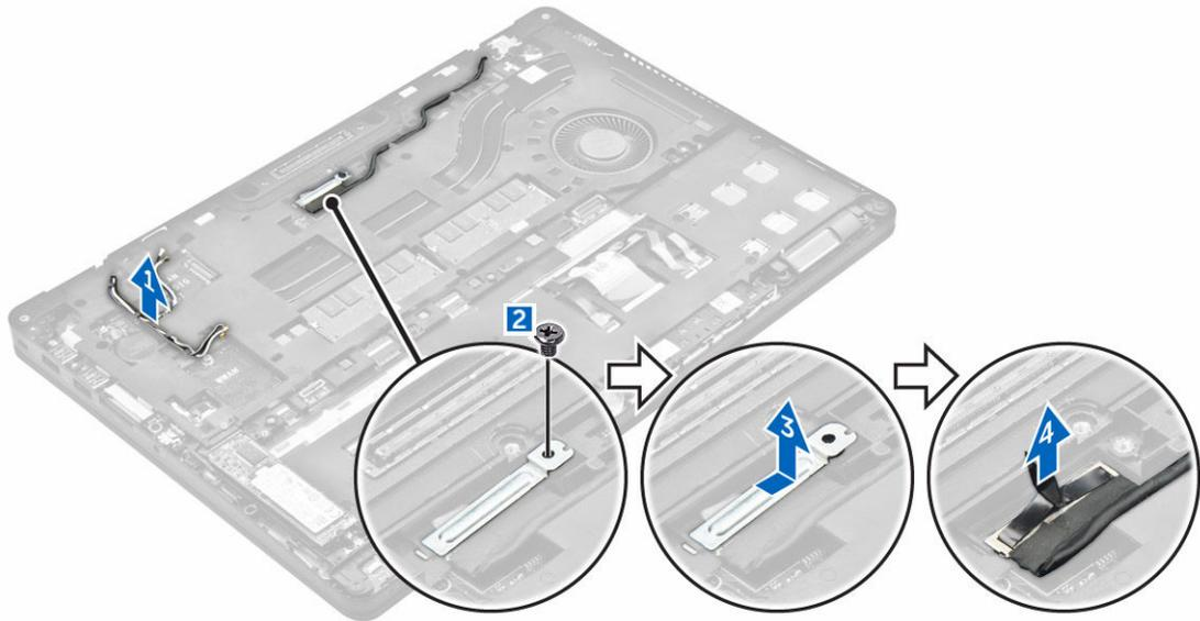
5. Para desconectar el ensamblaje de la pantalla:
