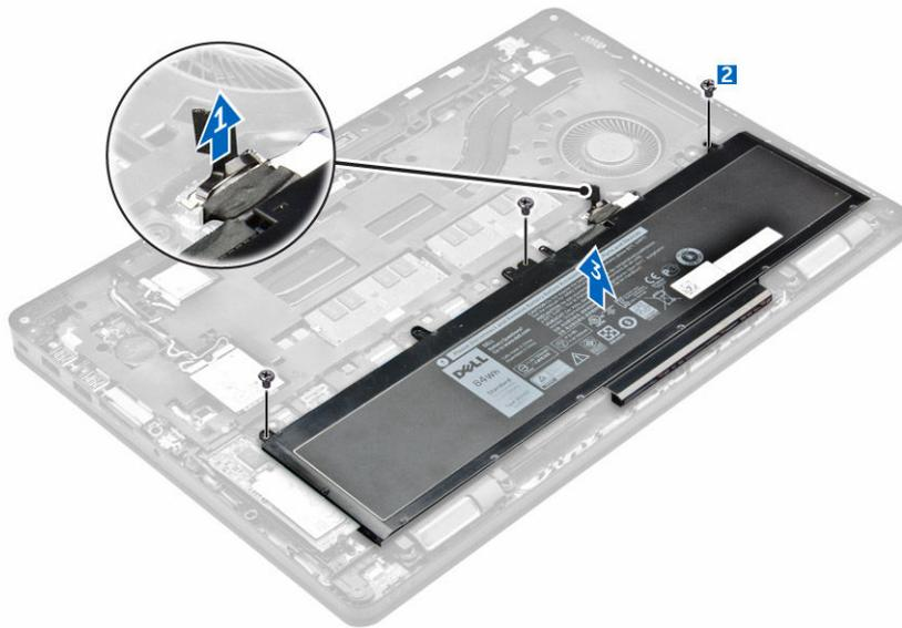
4. Desconecte el cable de la batería.
