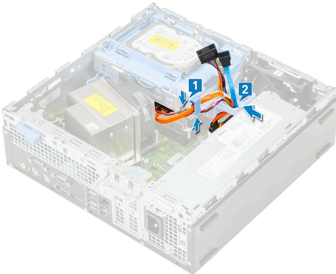
f Deslice la lengüeta de seguridad para bloquear el módulo [1].
