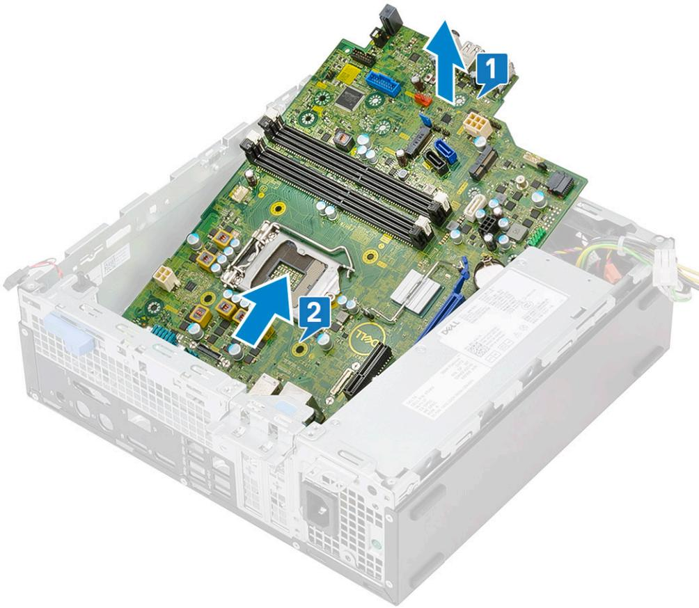
3 Coloque los 5 tornillos que fijan la tarjeta madre del sistema al sistema [1], el único tornillo (M3 x 5) [2] y el único tornillo (n.º 6-32) [3].
