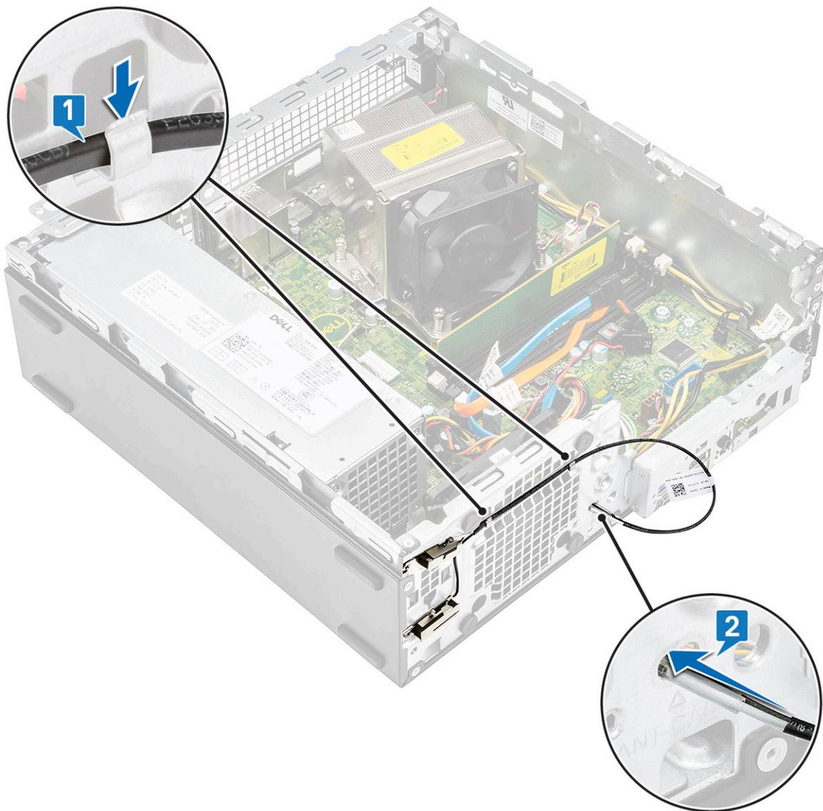
g Quite el tubo de plástico del cable de la antena interna.
