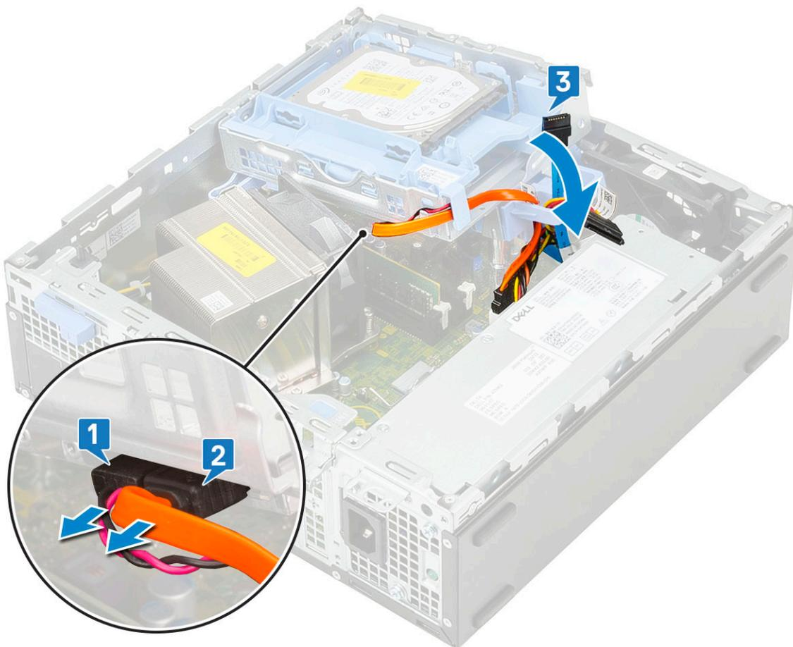
e Presione el pestillo de liberación de la unidad óptica [1, 2] y tire de la unidad óptica hacia fuera del sistema [3].
