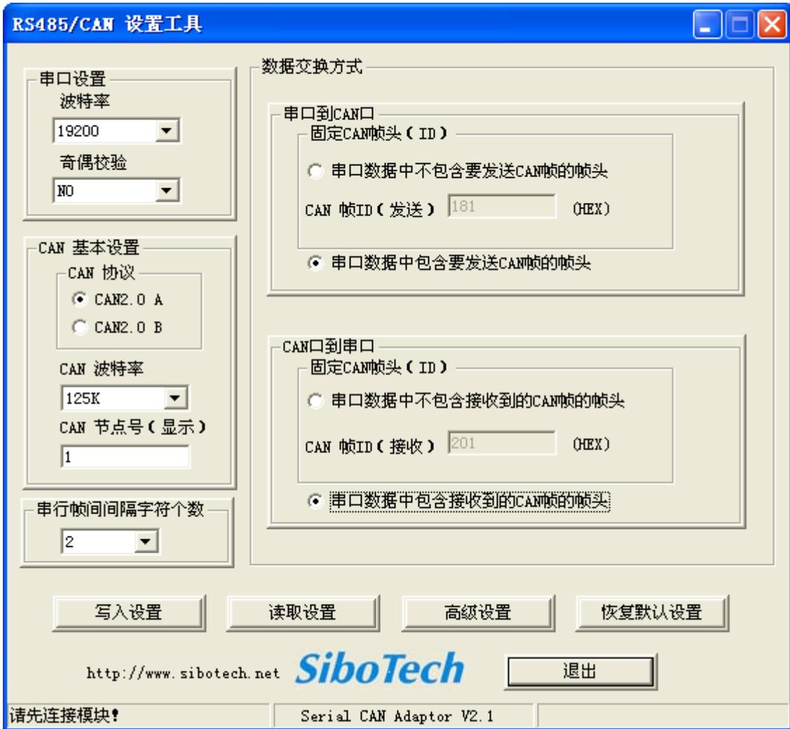
图 4.5 透明带标识符传输配置界面
