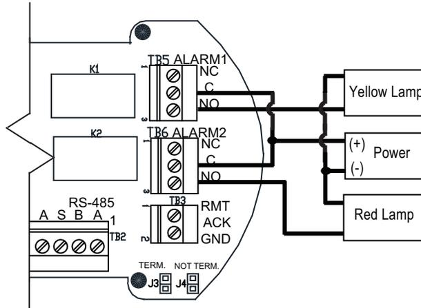
**Figura 21** Conexiones de relés y restablecimiento remoto de alarma -circuito del terminal/relé/MODBUS
