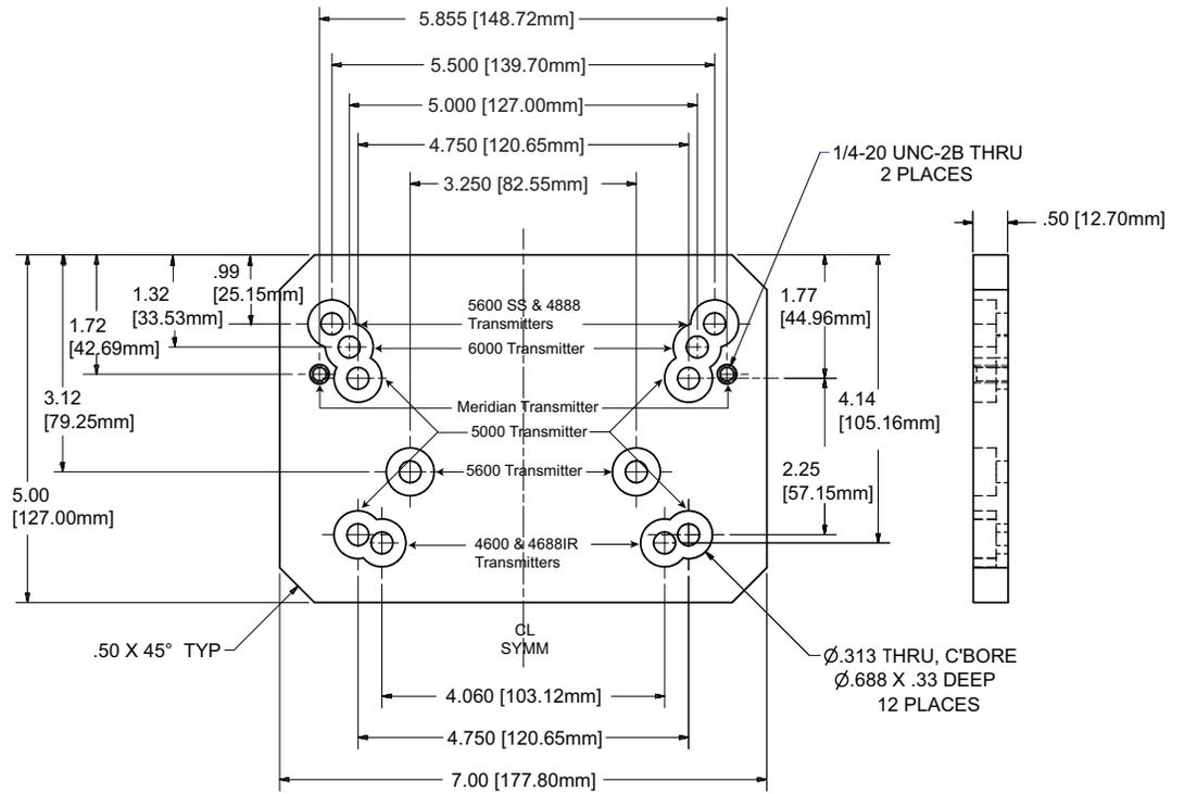
**Figura 8** Dimensiones de la placa de montaje de adaptación – HDPE
