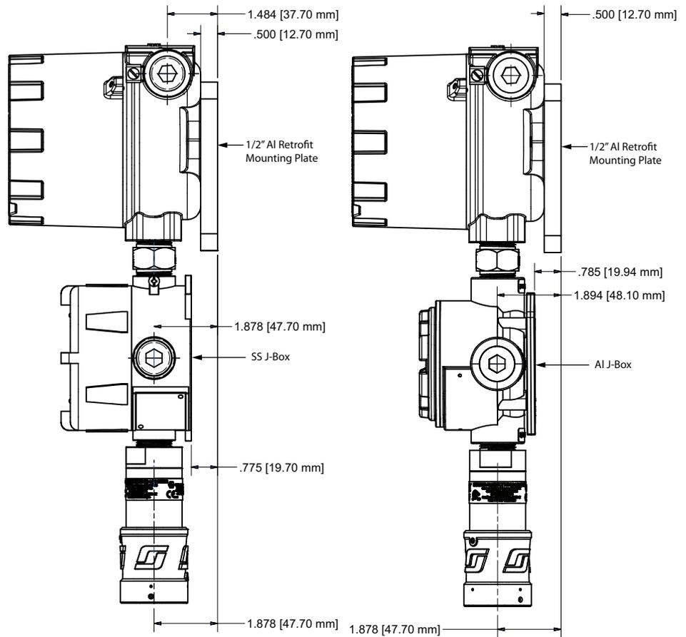
**Montaje del cuerpo de un detector Meridian mediante un accesorio de montaje en conducto**
