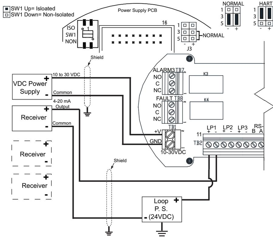
**Figura 19** Conexión para drenaje de 4 cables con fuente de alimentación de bucle aislado
