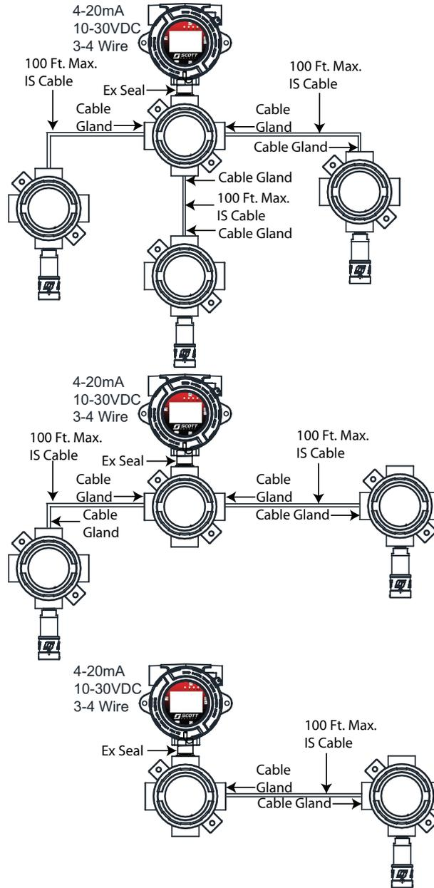
Nota: La distancia del cable intrínsecamente seguro desde el transmisor a cualquier sensor es de 30,48 m (100 Ft) como máximo. Planos de control de referencia: 096-3506-B para 3-4 cables y 096-3507-B para 2 cables.
