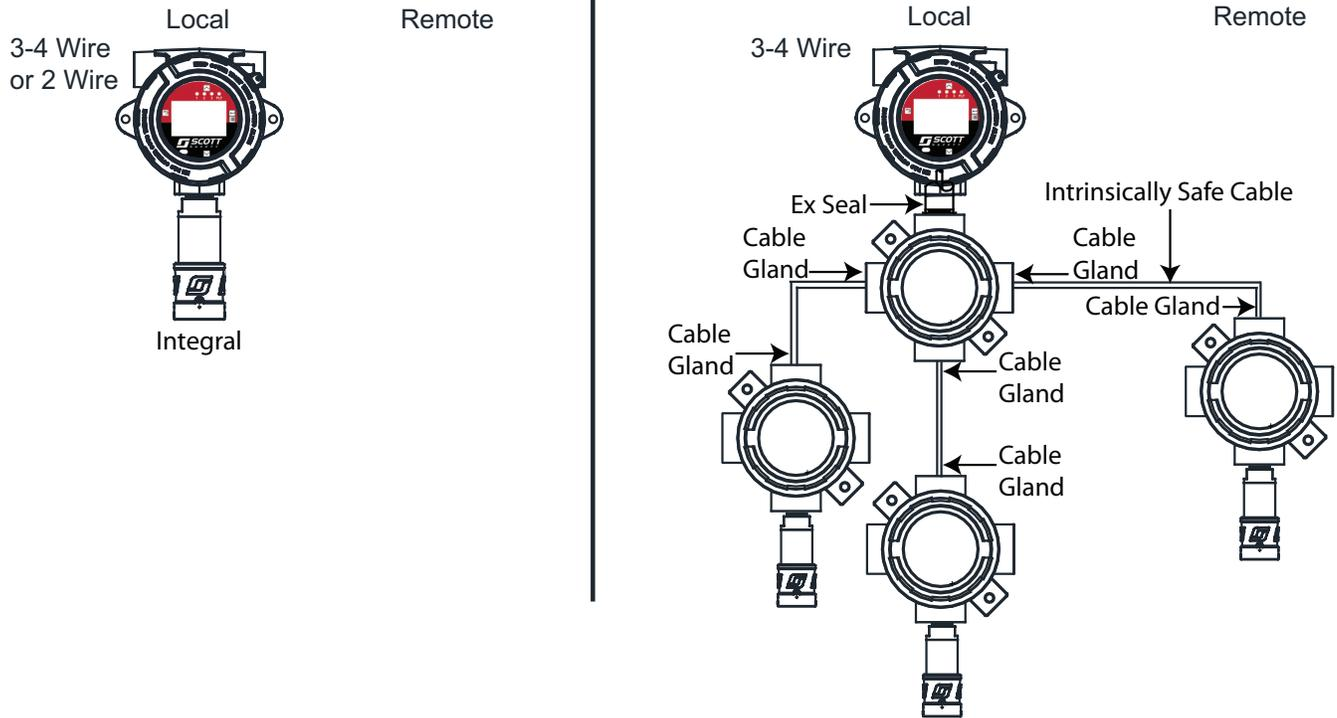
Nota: La distancia del cable intrínsecamente seguro desde el transmisor a cualquier sensor es de 30,48 m (100 Ft) como máximo. Planos de control de referencia: 096-3506-B para 3-4 cables y 096-3507-B para 2 cables.
