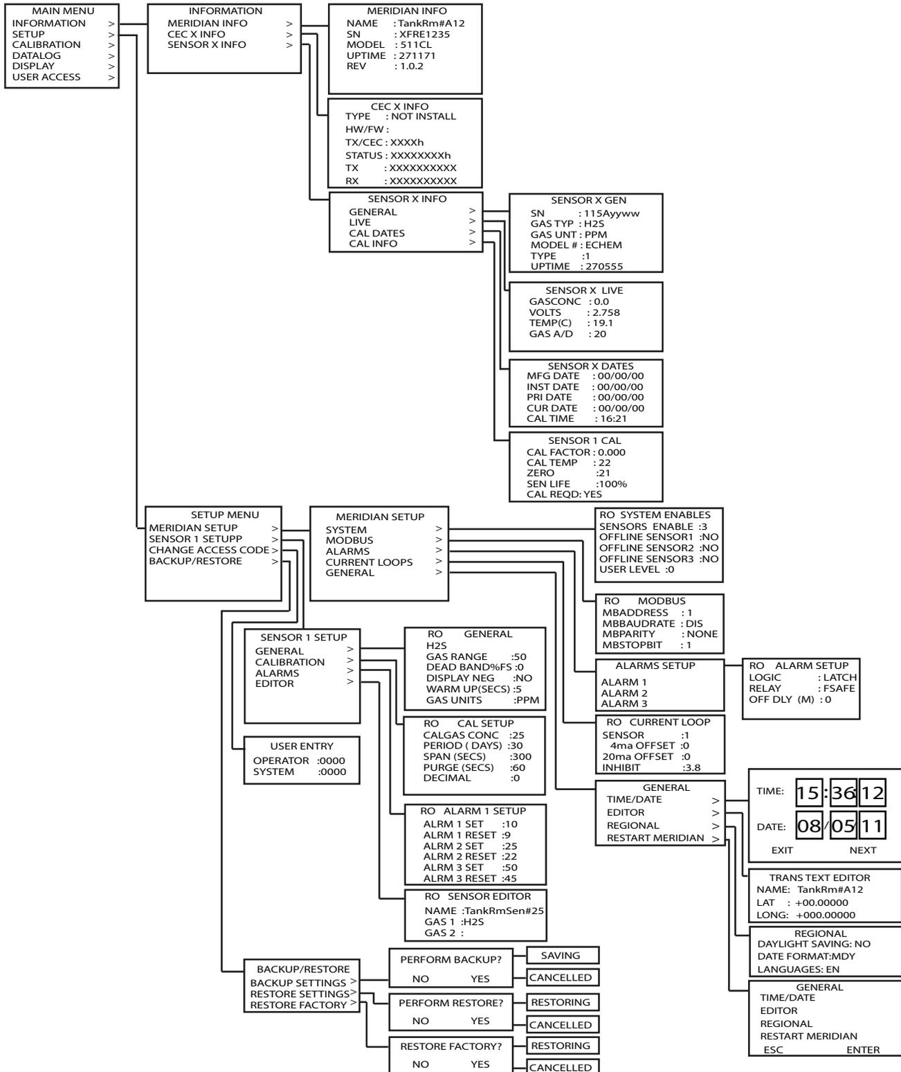
Figura 27 Estructura del menú de configuración – (2 de 2)
