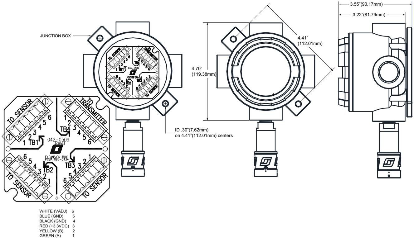
Nota: La distancia del cable intrínsecamente seguro desde el transmisor a cualquier sensor es de 30,48 m (100 Ft) como máximo. Planos de control de referencia: 096-3506-B para 3-4 cables y 096-3507-B para 2 cables.
