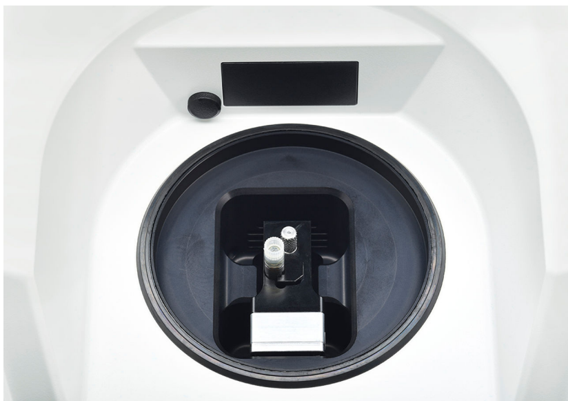
图4 将一次性样品瓶放在样品室中
