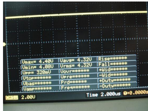
图 5.7 靠近漆包线时直流输出信号
