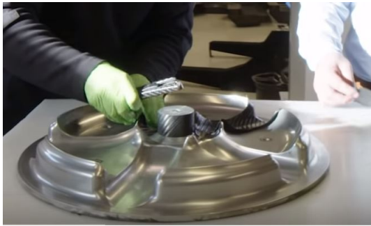
(a) Laminación de pieza superior
