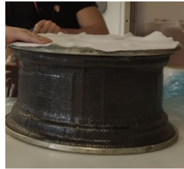
(b) Laminación de pieza inferior
