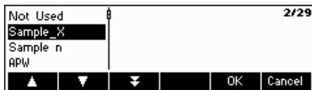
Use the «▼» and «▲» softkeys to select the desired function of the softkey, then press «OK».
