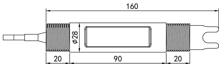
采用高纯度铂金制成的 ORP 复合电极，具有极强的抗酸碱能力和抗氧化能力，测量精度高、响应快、稳定性好，电极可根据温度自动补偿。
