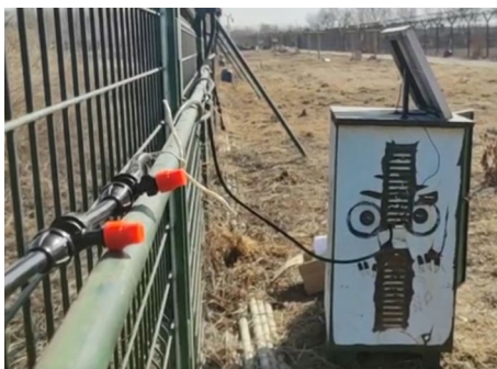
▲ 智能太阳能驱鸟剂喷洒设备
