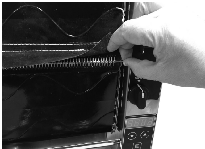
Figura 6. Instalación de las envolturas de la banda.
