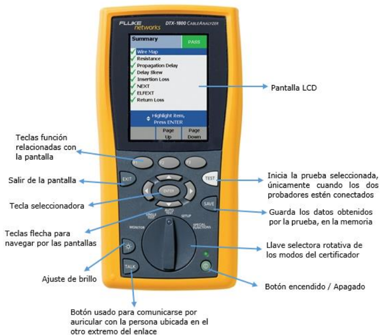
Figura 9. Identificación de los botones del certificador DTX 1800 Fuente: elaboración propia Manual Guía
