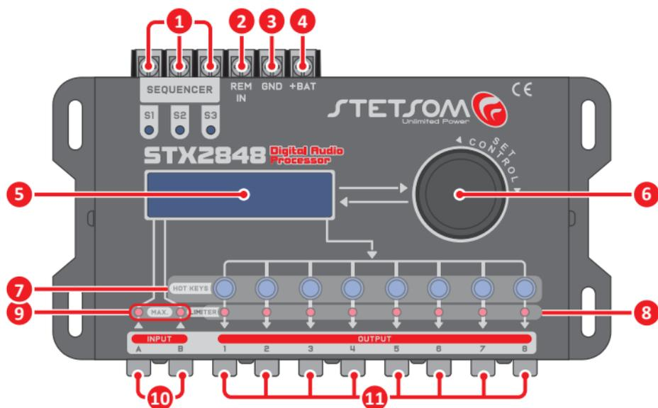
**1. SEQUENCER:** Permite la activación secuencial de otros productos a través de la conexión de activación remota (REM). Use un cable de al menos **0,5mm<sup>2</sup>**.
