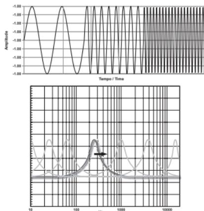
**Ruído Rosa:** Permite gerar um sinal que mantém a mesma magnitude para toda a escala de frequência, utilizado geralmente para calibrar sistemas de áudio a fim de obter resposta plana e com o devido alinhamento entre as vias. Cada aperto no **ENCODER** altera entre edição do parâmetro de ganho e ON/OFF. Com o ruído rosa ligado ainda é possível alterar o ganho do ruído em tempo real, e inclusive modificar outros parâmetros de áudio do processador.
