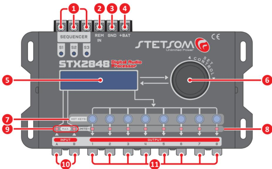
**1. SEQUENCER:** Consente l'attivazione sequenziale di altri prodotti tramite la connessione di attivazione remota (REM). Utilizzare un cavo di almeno **0,5mm<sup>2</sup>**.
