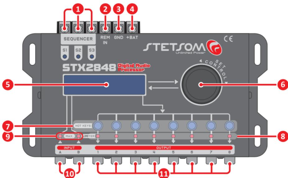
**1. SEQUENCER:** Permite o acionamento sequenciado de outros produtos através da conexão de acionamento remoto (REM). Utilize um cabo de no mínimo **0,5mm<sup>2</sup>**.
