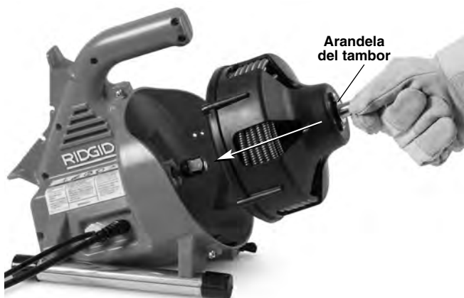
Figura 16 – Colocación del tambor dentro de la máquina
