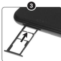
•**Inserir cartão SIM e cartão de memória:** Use a ferramenta fornecida para extração da bandeja do cartão SIM para removê-la da lateral do telefone. Coloque o cartão SIM dentro da bandeja e insira-o no dispositivo.
