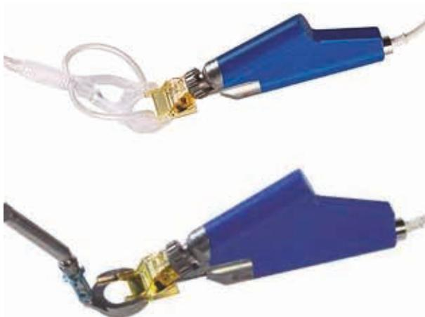
**Figura 4.** Moria SBK One Use-Plus (arriba con anillo de succión desechable; abajo con anillo de succión reutilizable). El cabezal deslizante del Moria SBK hace un movimiento lineal de avance sobre la córnea para crear el flap de LASIK con una bisagra nasal.
