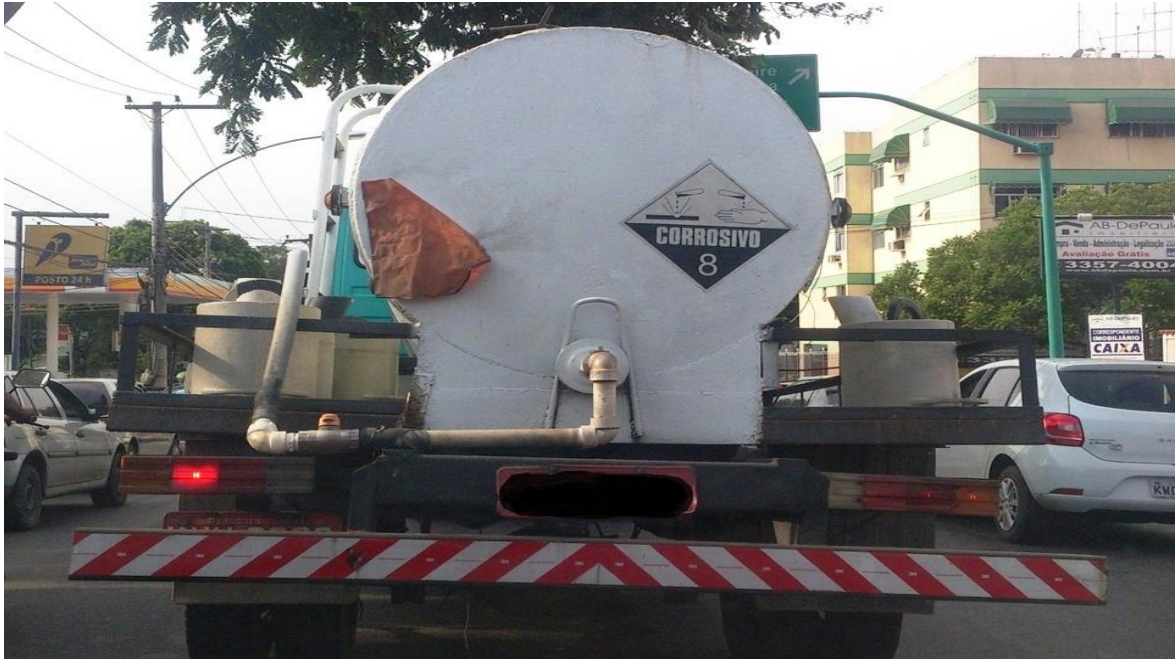
Figura 12: Erro de identificação no painel de segurança. Fonte: Daniel Campos Correia.
