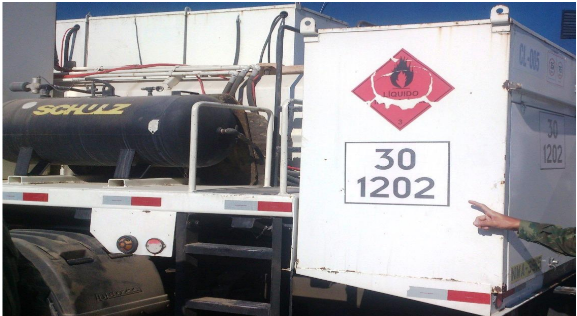
Figura 8: Erro de identificação no painel de segurança – cor errada. Fonte: Daniel Campos Correia.
