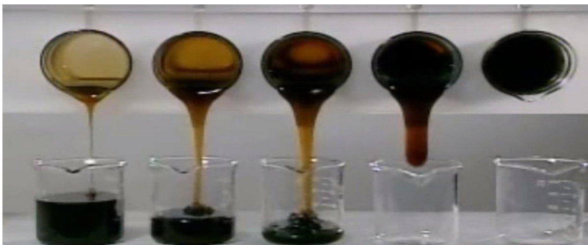
Figura 4 – Líquidos com viscosidades diferentes. Da esquerda para a direita aumenta a viscosidade. Fonte: http://www.manutencaopreditiva.com .
