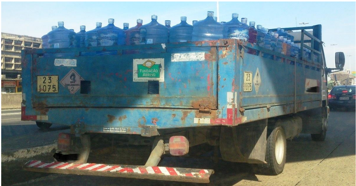
Figura 13: Transporte inadequado, em vez de gás inflamável é transportado água. Fonte: Daniel Campos Correia.
