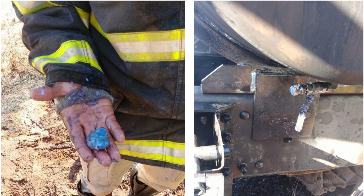
Figura 44 – Acidente atendido pelo CBMMS com a utilização de massa de vedação - sabão. Fonte: Nayara de Souza Olarte, 2017.
