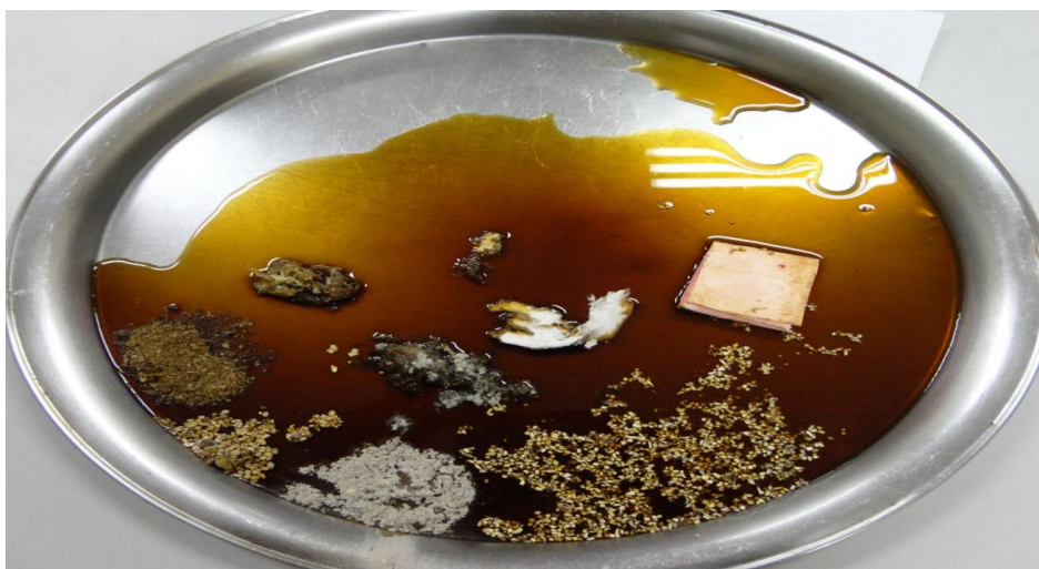
Figura 46 – Absorvente/adsorventes sintéticos e orgânicos – velocidade de contenção – Treinamento GOPP/COPP. Fonte: Wanderley Valério de Oliveira, 2012.
