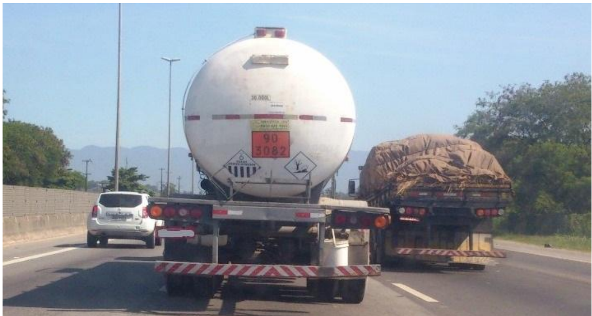
Figura 9: Erro de identificação no painel de segurança e rótulo de risco – número de risco incompatível. Fonte: Daniel Campos Correia.
