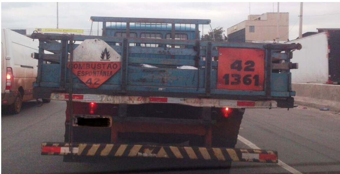
Figura 11: Transporte inadequado e erro de identificação no painel de segurança e rótulo de risco. Fonte: Daniel Campos Correia.
