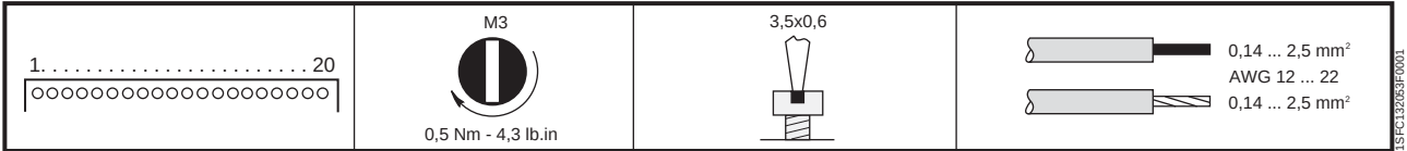
Figura 16: Binários de aperto e dimensões dos cabos (1 mm=0,0394 pol)
