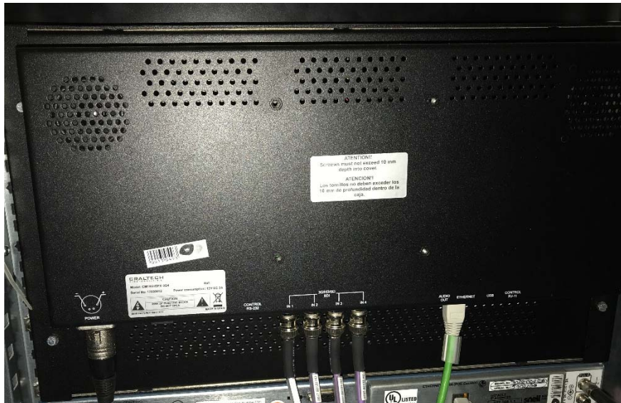
Figura 37 - Trasera de uno de los monitores Craltech 24" del puente de monitoreo
