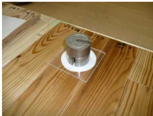
写真 3 - 2 0 吸水速度測定状況
