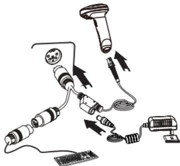
1. PS/2 ケーブルを (RJ 45コネクタ側) HR100のケーブルスロットへ挿入します
