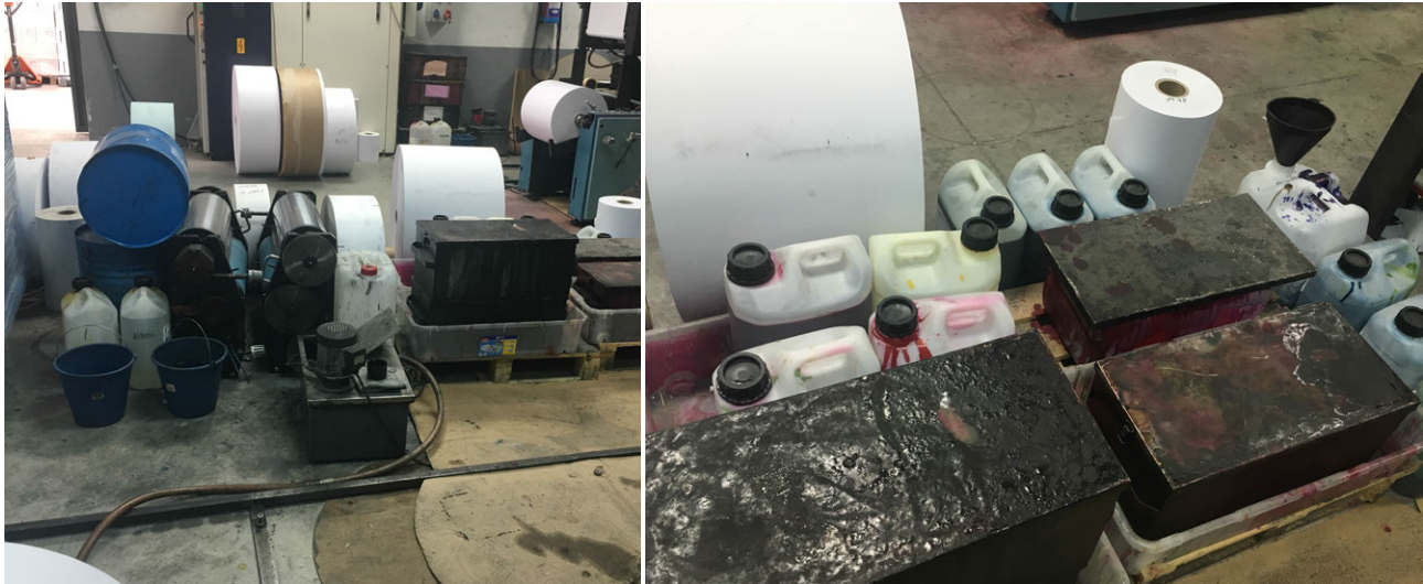
Figura 64. Colocación de anilinas. Cada máquina cuenta con sus depósitos propios.
