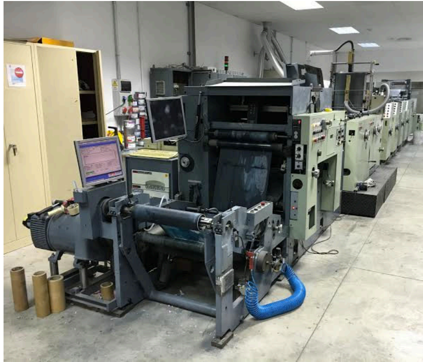
Figura 40. Goebel Optiforma con equipo de control numérico
