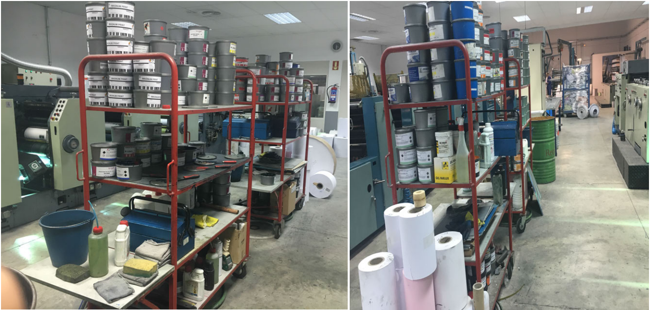
Figura 62. Disposición de las tintas ordenadas, junto con las herramientas necesarias (espátulas, productos de limpieza etc.) junto a las máquinas.
