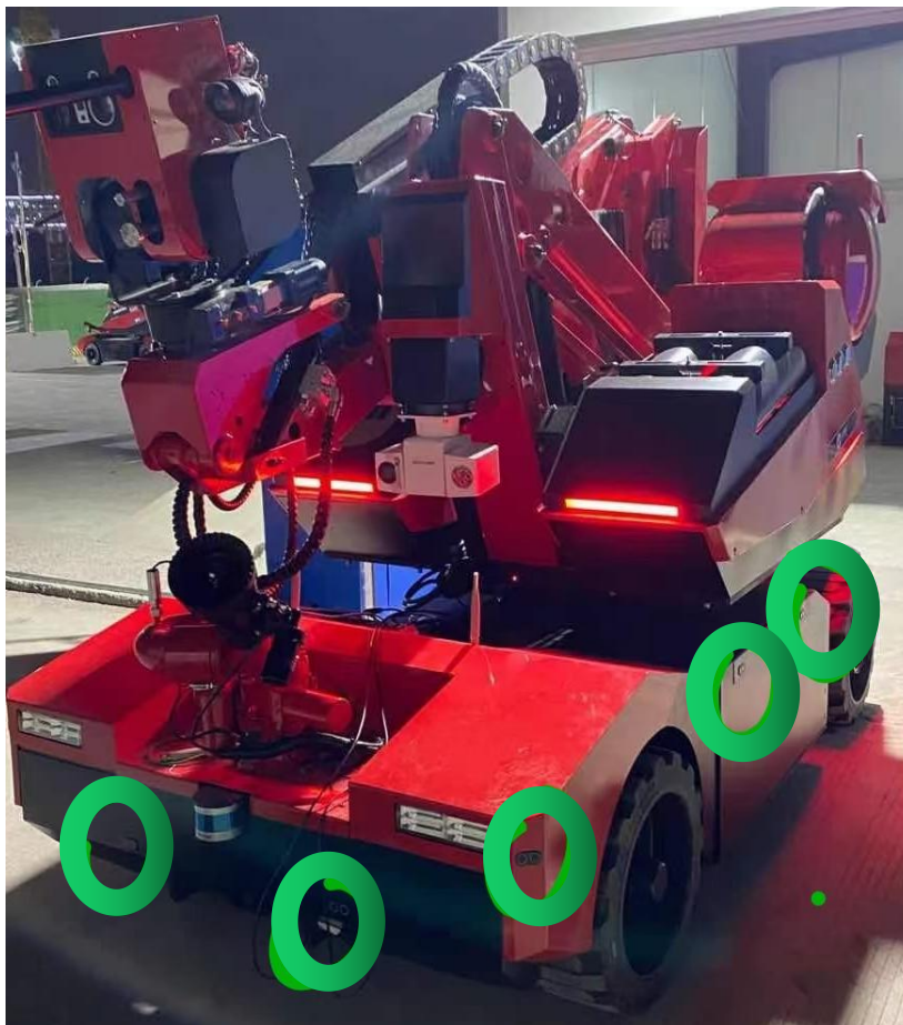
作业机器人（360° 环绕KS104/KS114，形成高精度空气皮肤）
