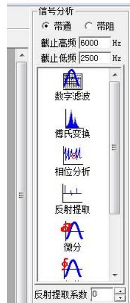
指数放大、数字滤波、积分、微分、傅立叶变换等均为通用分析功能，数字滤波为一带通滤波器，带通范围缺省为“2500~6000HZ”，带通滤波器的截止低频和截止高频可以从信号分析栏中直接输入，也可以在付氏变换后的频谱曲线上点击鼠标右键，在弹出菜单上选截止高频或截止低频设置。弹出菜单上的这两个功能只有在频谱分析曲线上且取用了“十字型光标”后才有效。相位分析和反射提取为本系统特有的功能，现在作详细介绍。
