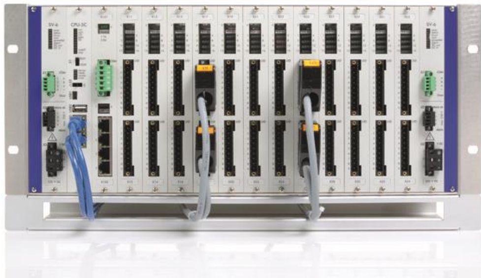
Abbildung 19: BCU-50 mit SV-6 Hauptversorgung und redundanter SV-6
