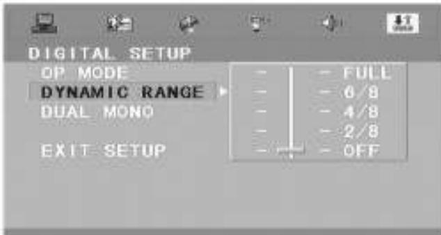
**RANGO DINÁMICO:** Cuando se selecciona el saque de línea [LINE OUT], escoja esta configuración para ajustar la proporción de saque de línea y tener un efecto diferente. Si se ajusta completamente [FULL], el valor máximo de la señal de audio será mínimo; mientras que si se ajusta a Apagado [OFF], será máximo.
