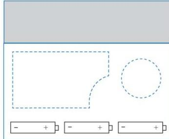
Para sustituir los acumuladores: abra la tapa del compartimento de los acumuladores (nº 8 en el capítulo 3.1) con una herramienta plana (p.ej. un destornillador o una moneda), inserte los acumuladores y asegúrese de que queden colocados en la orientación correcta (véase el dibujo).
