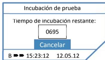
Pulse "START" (utilizando el botón INTRO (5)) en la pantalla "Selección de prueba" para que comience la cuenta atrás del tiempo de incubación (p.ej. 720 segundos si se seleccionó el método "CAL\_720" como "Método"). Esa pantalla no aparece cuando como "Método" se selecciona un método sin tiempo de incubación automático (p.ej. "CAL\_0"). La cuenta atrás del tiempo de incubación se puede cancelar pulsando "Cancelar" (utilizando el botón INTRO (5)).
