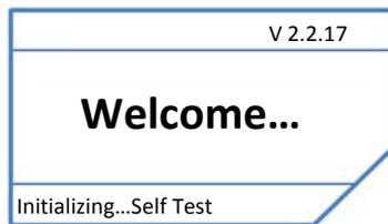
Tras encender el lector, se llevan a cabo automáticamente una autocomprobación del dispositivo, una comprobación del detector, la inicialización del motor y la memoria, y una comprobación de la calibración.
