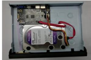
3、用螺丝将硬盘固定在底板的硬盘螺丝孔位上。
