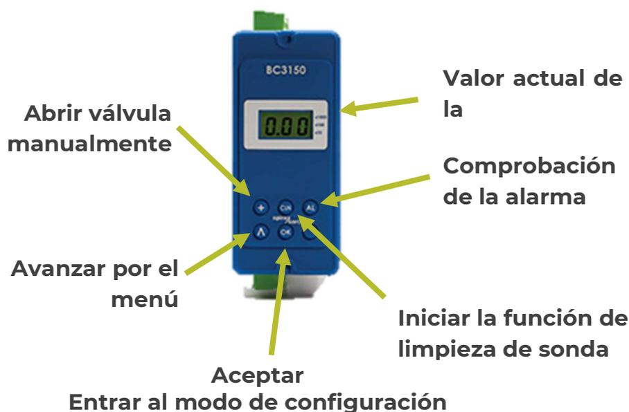
**AL** Esta tecla se puede utilizar para comprobar el relé de alarma y los circuitos externos. El controlador mostrará "AL" + "tSt" (test) + "PV" (conductividad). La alarma sólo se produce mientras se pulsa la tecla.
