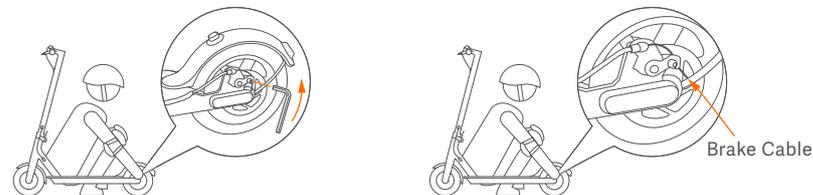
Bevor Sie Einstellungen vornehmen, stellen Sie sicher, dass der Roller ausgeschaltet ist und nicht lädt. Wenn die Bremse zu fest / locker ist, lösen Sie die Schraube am Bremsattel mit dem 4-mm-Inbusschlüssel. Stellen Sie dann die Bremsleitung leicht ein (verringern / erhöhen Sie die freiliegende Länge) und ziehen Sie die Schraube wieder an.
