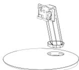
(2) 将立柱扣入底座卡口处，顺时针旋转回正立柱并听到“咔”一声即安装完成。
