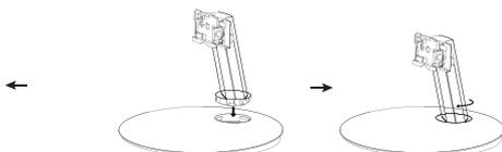
(3) 取出显示器，并安装把支架及底座安装到显示器上。
