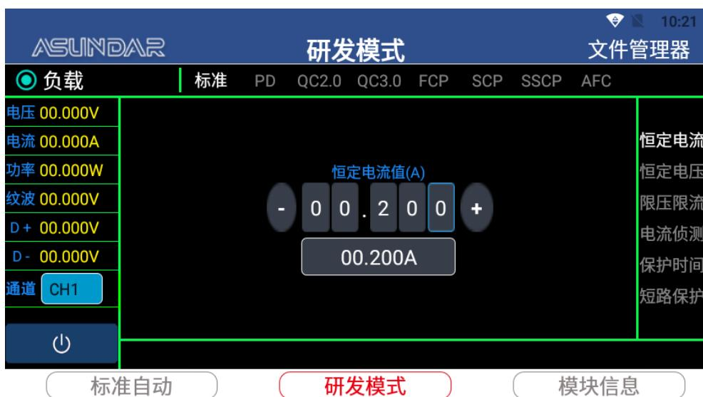
**PD负载**：选择“PD3.0”，可识别并触发产品的PD2.0及PD3.0协议。
