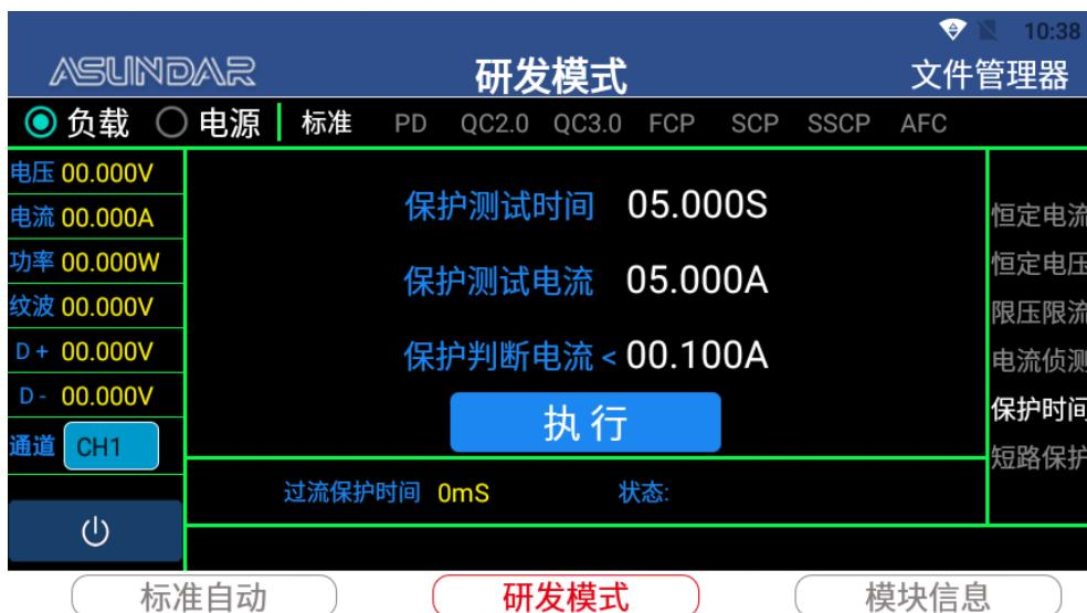
**短路保护：**选择“短路保护”，可测试产品从短路到进入保护状态所需时长。
