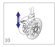
刹车/解刹: 往下压刹车柄,听到卡一声即已刹车。 往上推刹车柄,听到卡一声即已解刹。 注意:车台处于非移动状态时请务必刹 车。
