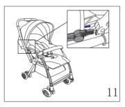
安装遮阳篷 沿着箭头方向将遮阳篷插扣在孔位里, 直到完全锁定为止。
