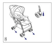
旋转前后轮 & 固定前后轮 将前后轮定位锁往下推,听到卡一声前 后轮即可旋转。
