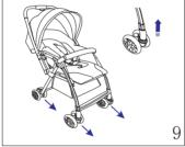
旋转前后轮 & 固定前后轮 将前后轮定位锁往上推,听到卡一声前 后轮即可固定。
