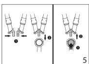
安装前扶手 沿着箭头方向将前扶手扣在前支架上, 直至完全锁定为止。
