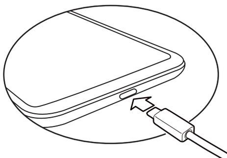
1. 将USB同步传输线按正确的方向连接至手机底部的USB端口；
