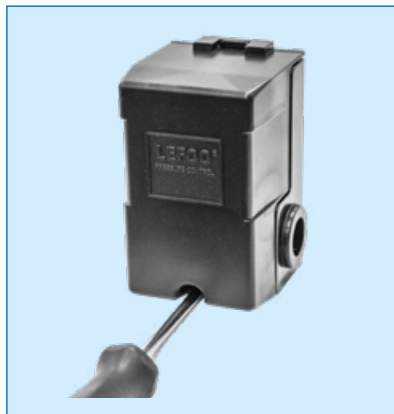
Figura 13 - Remoção do parafuso da tampa
